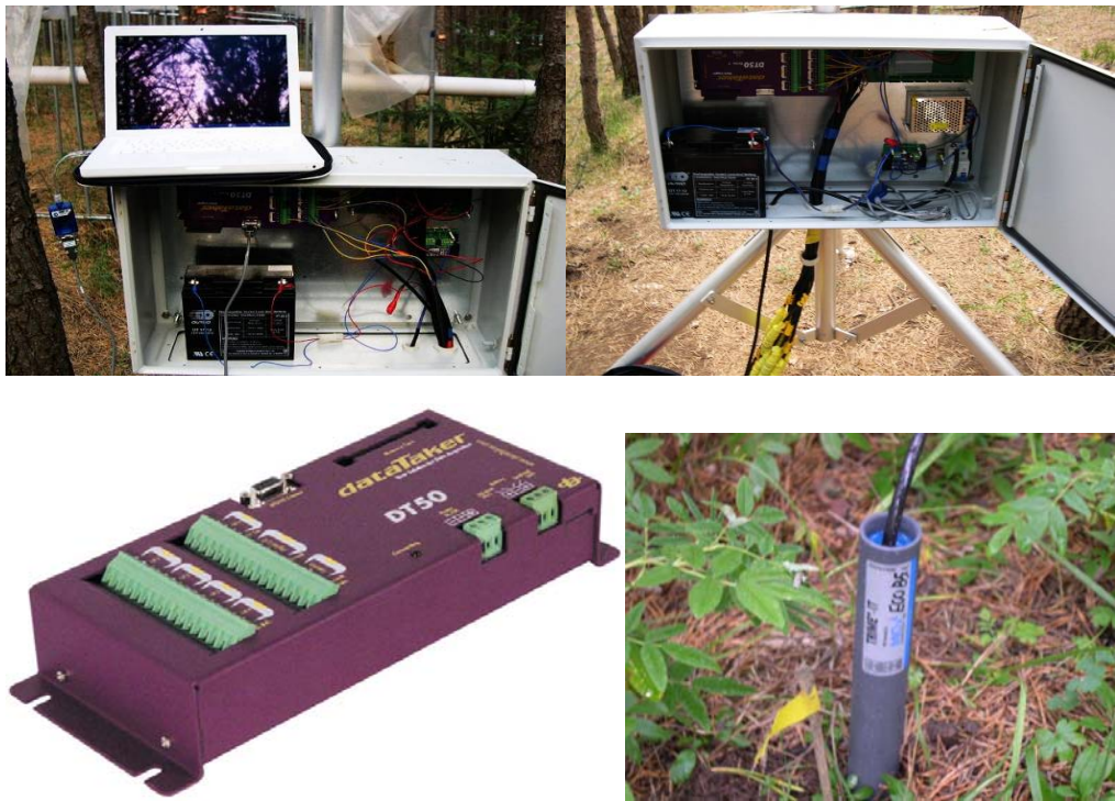
图 2-9 AZ-DT 土壤水分监测系统
